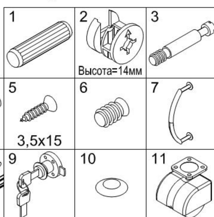
Поставить каркас на роликовые опоры. Вставить ящики. Если требуется, вынуть ящики и отрегулировать их положение, сместив направляющие или вставив между боковинами и направляющими шайбы (10).
