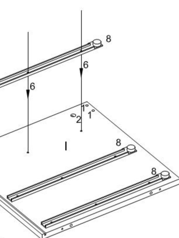
Положить верхнюю и нижнюю полку глухими отверстиями вверх. Забить в верхнюю и нижнюю полки на клей шканты (1). Вкрутить в верхнюю полку дюбеля стяжек-эксцентриков (3). Соединить боковины. Надеть каркас из боковин на верхнюю полку и затянуть отверткой стяжки-эксцентрики (2) на боковинах. Вставить в пазы боковин и паз верхней полки заднюю стенку. Надеть на каркас нижнюю полку и прикрепить винтами "Директа" (4). Прикрепить к нижней полке шурупами (5) роликовые опоры (11) (см.рис.5).
