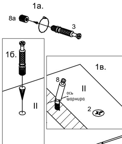
Положить стенки боковые (II, III) и планку продольную (IV) отверстиями вверх. Ввернуть дюбель (3) в пластиковую муфту (8а) (рис. 1а). Забить в боковины (II, III) дюбеля с установленной муфтой (8а) так, чтобы **верхний край муфты относительно плоскости боковины был притоплен на 3-4мм**. Вывернуть дюбель (3) и ввернуть в муфту шарнирный дюбель. **Ось шарнира должна совпасть с плоскостью боковины и быть параллельной вертикальным торцам боковин** (рис. 1, 1б и 1в).
