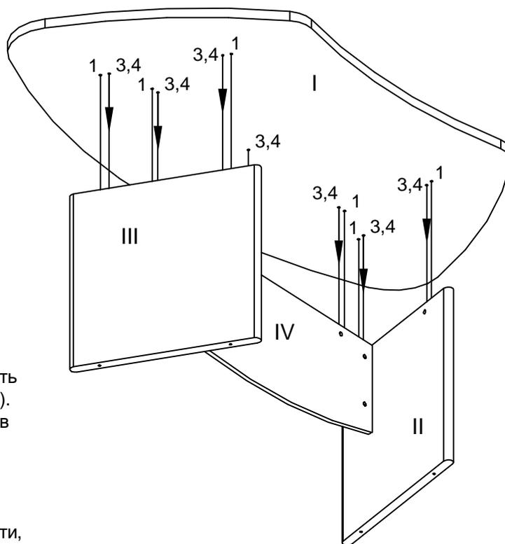
Положить столешницу (I) отверстиями вверх. Забить в столешницу (I) шканты (1) и канговые футорки (4). Вкрутить в канговые футорки дюбеля (3) до упора в обод. Надеть столешницу (I) на каркас и затянуть отверткой стяжки-эксцентрики (2) на стенках боковых (II, III) и планке продольной (IV). Закрепить торцы стяжек-эксцентриков декоративными заглушками (7). Отрегулировать, при необходимости, высоту стола, подвинтив опоры (5).
